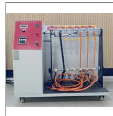
线材弯折试验机
