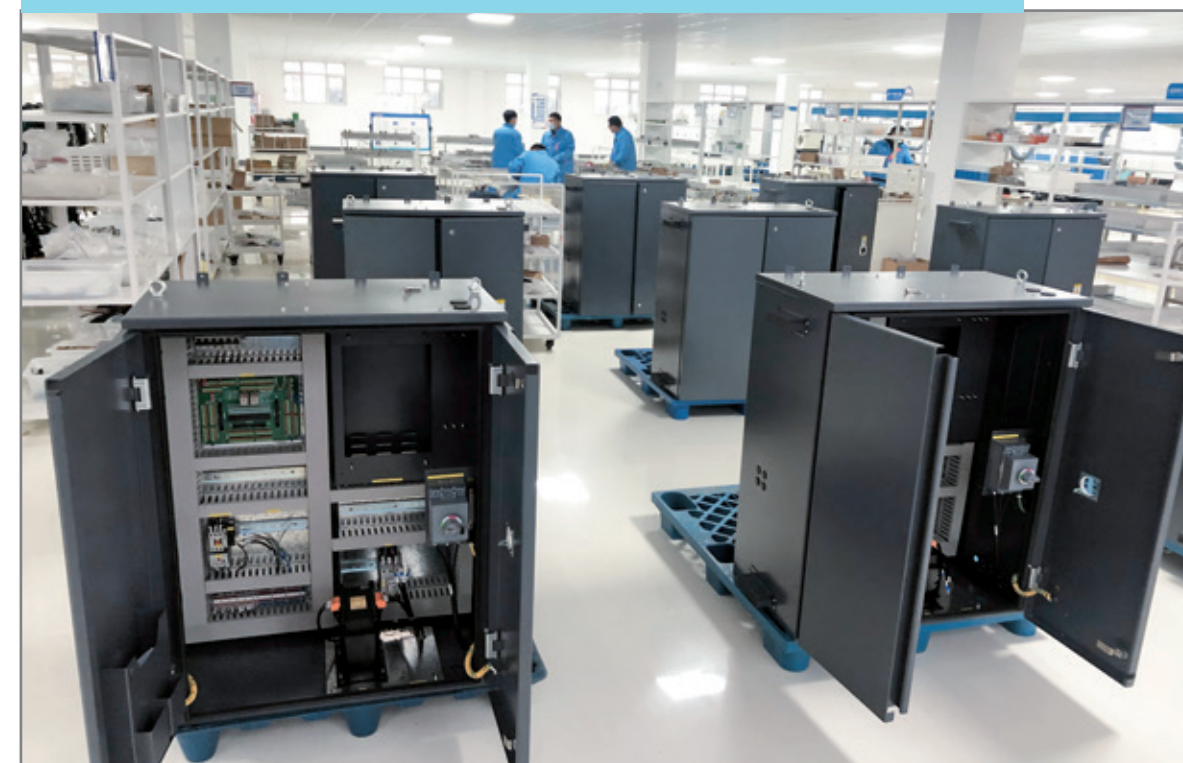
配电柜生产 组装现场
